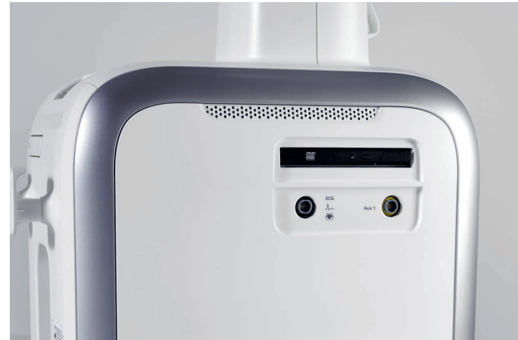
Connecteur de câble ECG, graveur DVD et port physio.
