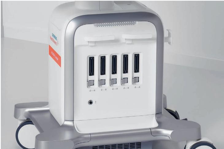
Flux de travail efficace, grâce aux 5 ports de sonde actifs et 1 port CW.
